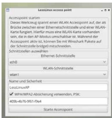
Steht kein DSL-Router mit Mitschnittfunktion bereit, können Sie CDI als Access Point konfigurieren. Hierfür wird eine WLAN-Karte benötigt, die sich im Access Point-Modus betreiben lässt und eine Ethernetverbindung zum DSL- oder Kabel-Router. WLAN-zu-WLAN-Brücken sind mit dem Assistenten noch nicht möglich, selbst wenn der Chipsatz dies unterstützt oder mehrere WLAN-Karten vorhanden sind. Linux versierte Nutzer können diese aber auf der Kommandozeile unter
